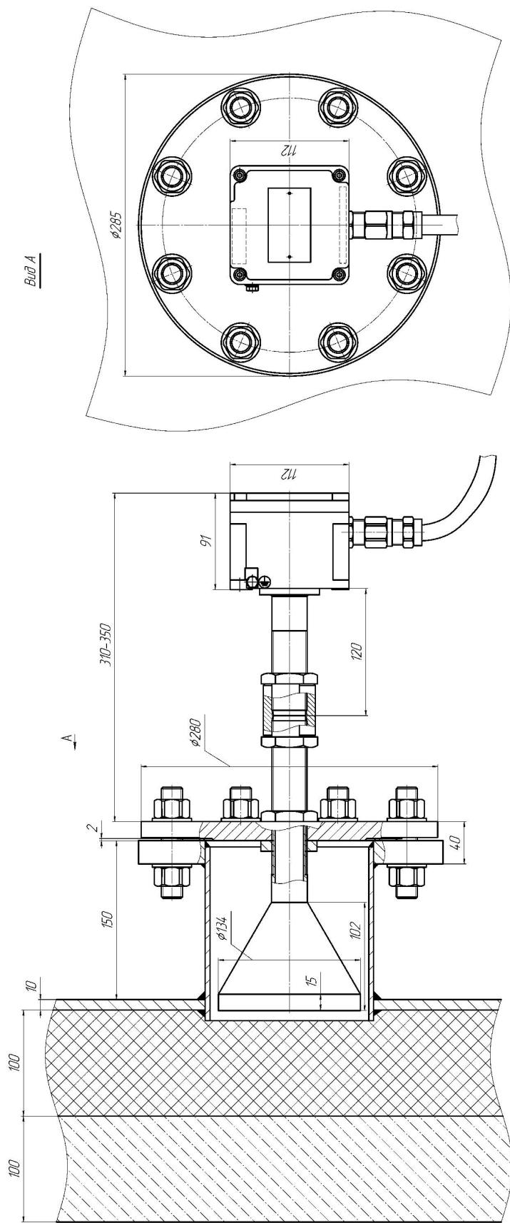
**Приложение 6. Чертеж крепления блоков ПД и ПМ с цилиндрическими излучателями на стенке бетонного бункера**
