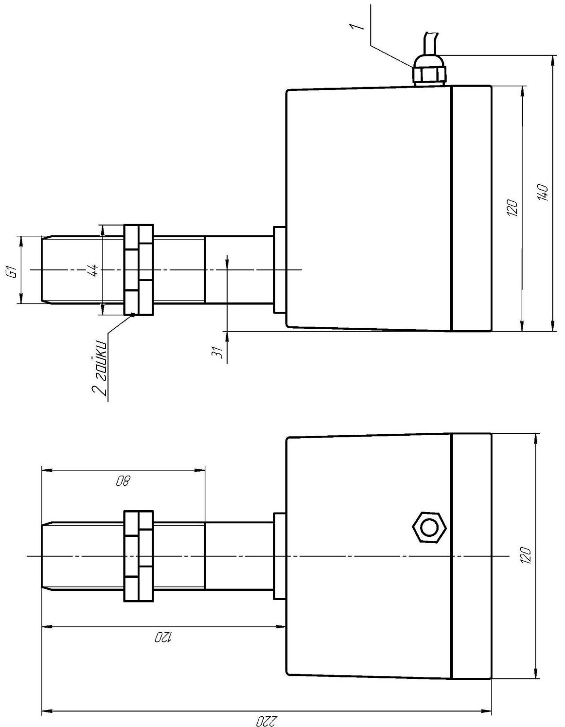
**Приложение 2. Схема электрическая соединений сигнализатора СИУР-03В2.5М Чертеж блоков ПД и ПМ сигнализатора СИУР-03В2.5 и СИУР-03В2.5М**
