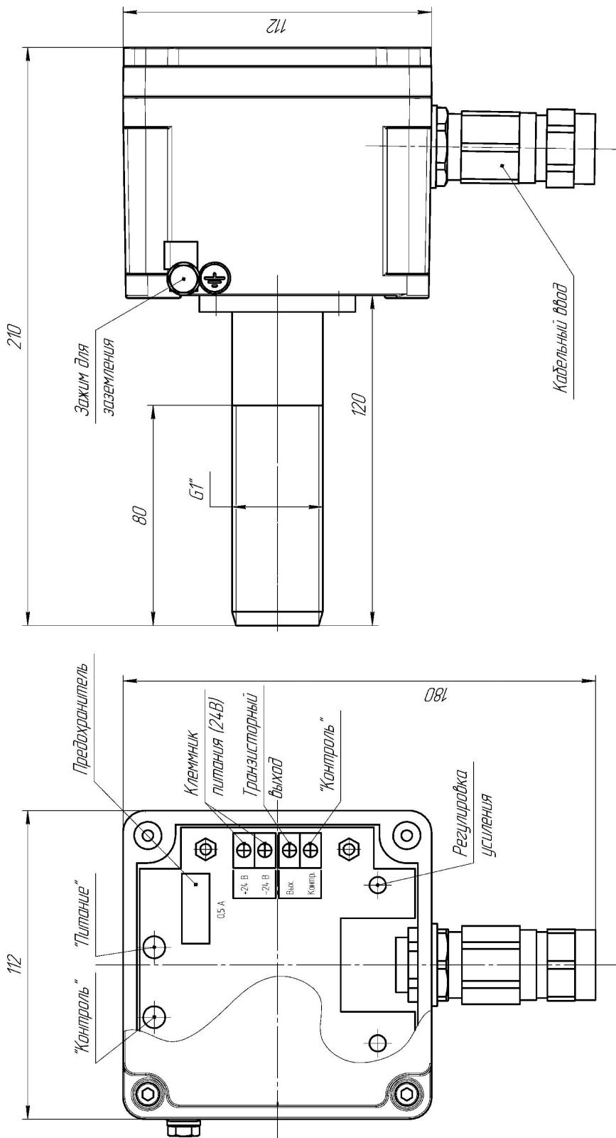
**Приложение 3. Чертеж блоков ПД и ПМ сигнализатора СИУР-03В2.6**
