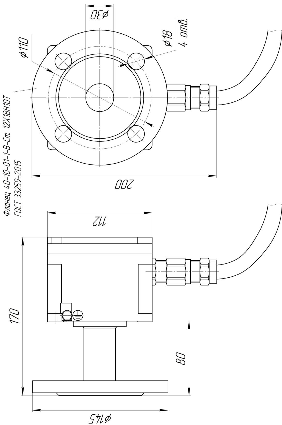
**Приложение 5. Чертеж крепления блоков ПД и ПМ с рупорными антеннами на стенке бетонного бункера**
