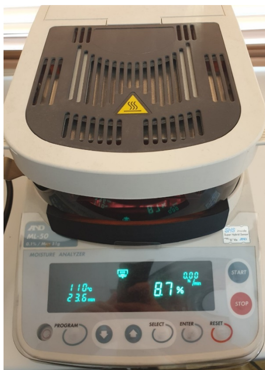
Рис.1. Анализатор влажности AND ML-50 для измерения термогравиметрическим методом
