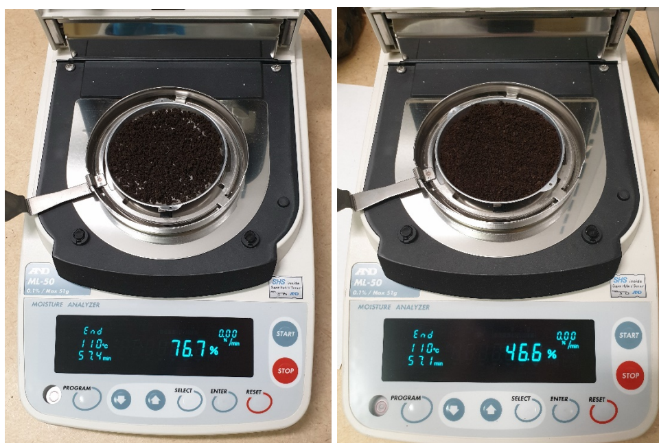
Рис.1. Анализатор влажности AND ML-50 для измерения термогравиметрическим методом
