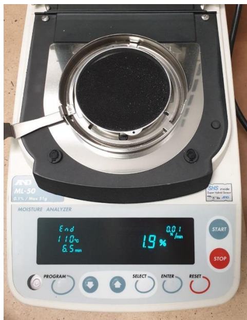
Рис.1. Термогравиметрический анализатор влажности AND ML-50
