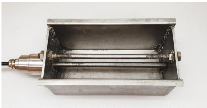
Рис.2. Датчик влагомера FIZEPR-SW100.30.2
