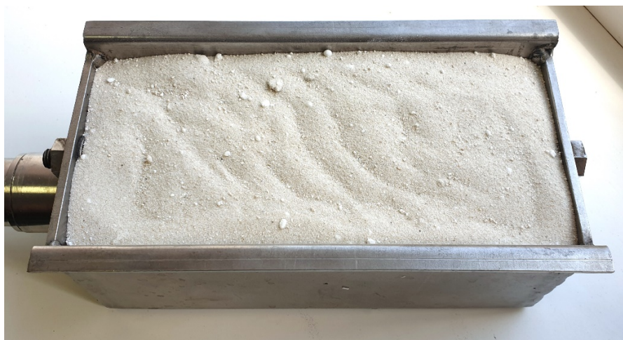
Датчик влагомера FIZEPR-SW100.30.2 с шихтой
