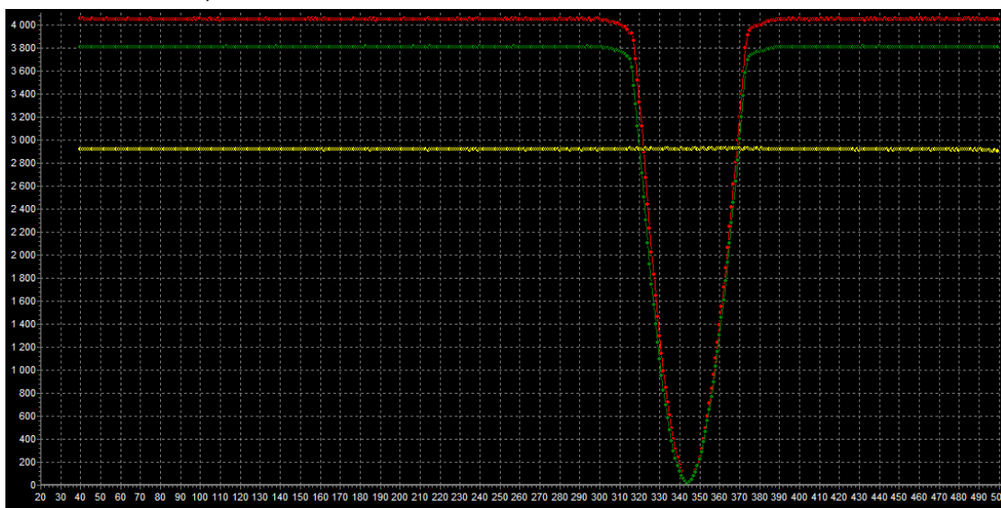
Рис.7. Спектр сигнала влагомера FIZEPR-SW100.30.2 при заполнении кюветы образцом сульфата аммония с влажностью W = 0,2\%
