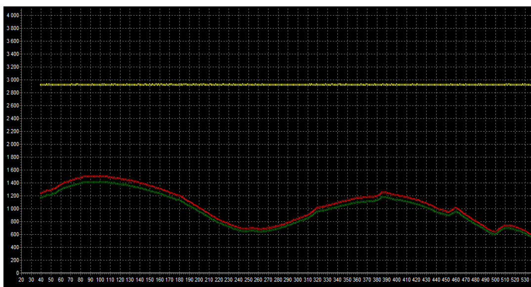
Рис.8. Спектр сигнала влагомера FIZEPR-SW100.30.2 при заполнении кюветы сульфатом аммония с влажностью W= 2,68\%
