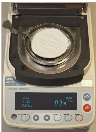
Рис.1. Анализатор влажности AND ML-50 для измерения термогравиметрическим методом
