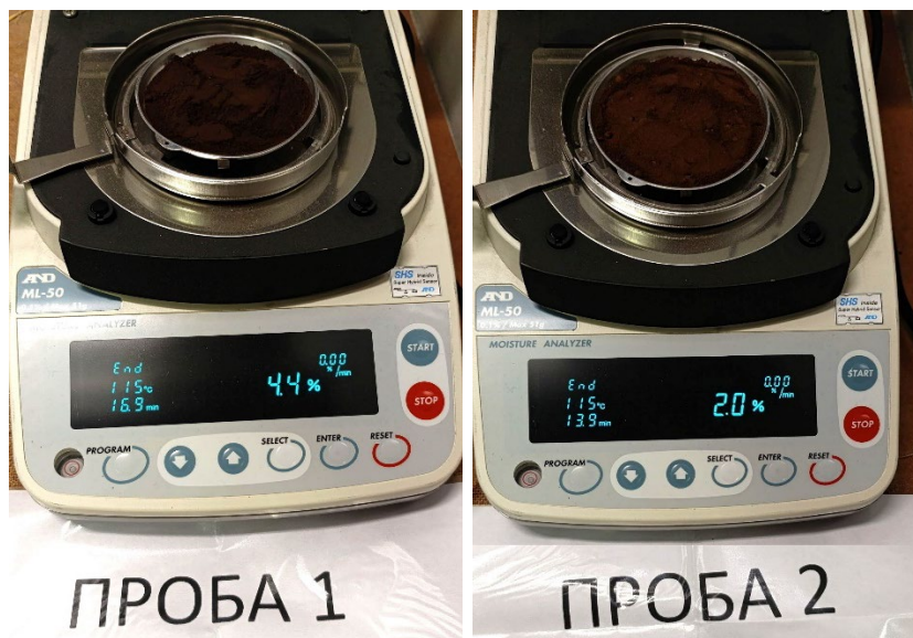
Рис.1. Анализатор влажности для контроля методом сушкой
