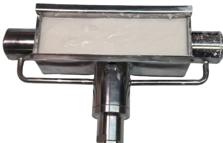
Рис. 8. Датчик FIZEPR-SW100.30.261, заполненный пищевой содой влажностью W = 17\%
