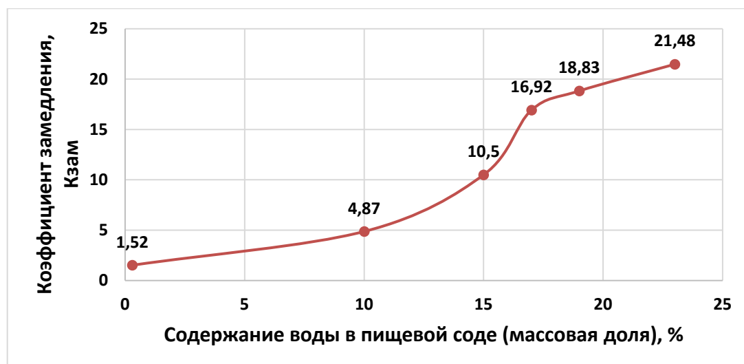
Рис. 6. График зависимости коэффициента K_{зам} от влажности бикарбоната натрия для влагомера FIZEPR-SW100.30.261
