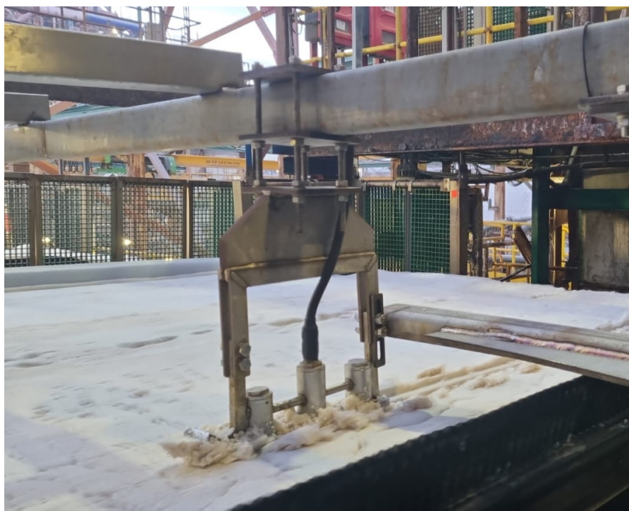
Рис. 10. Влагомер FIZEPR-SW100.10.561 на конвейере завода фирмы ICL
