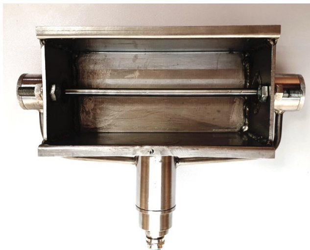
Рис.1. Датчик влагомера FIZEPR-SW100.30.26
