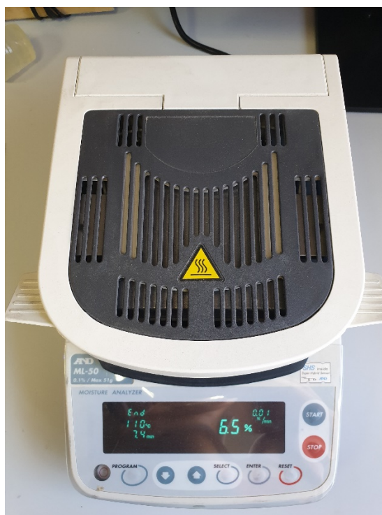
Рис. 5. Измерение начальной влажности термогравиметрическим влагомером второго образца золотосодержащего концентрата ВУК
