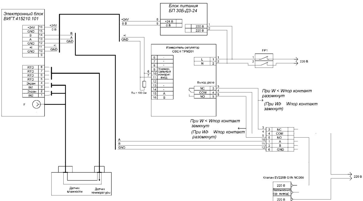
Схема подключения влагомера FIZEPR-SW100
