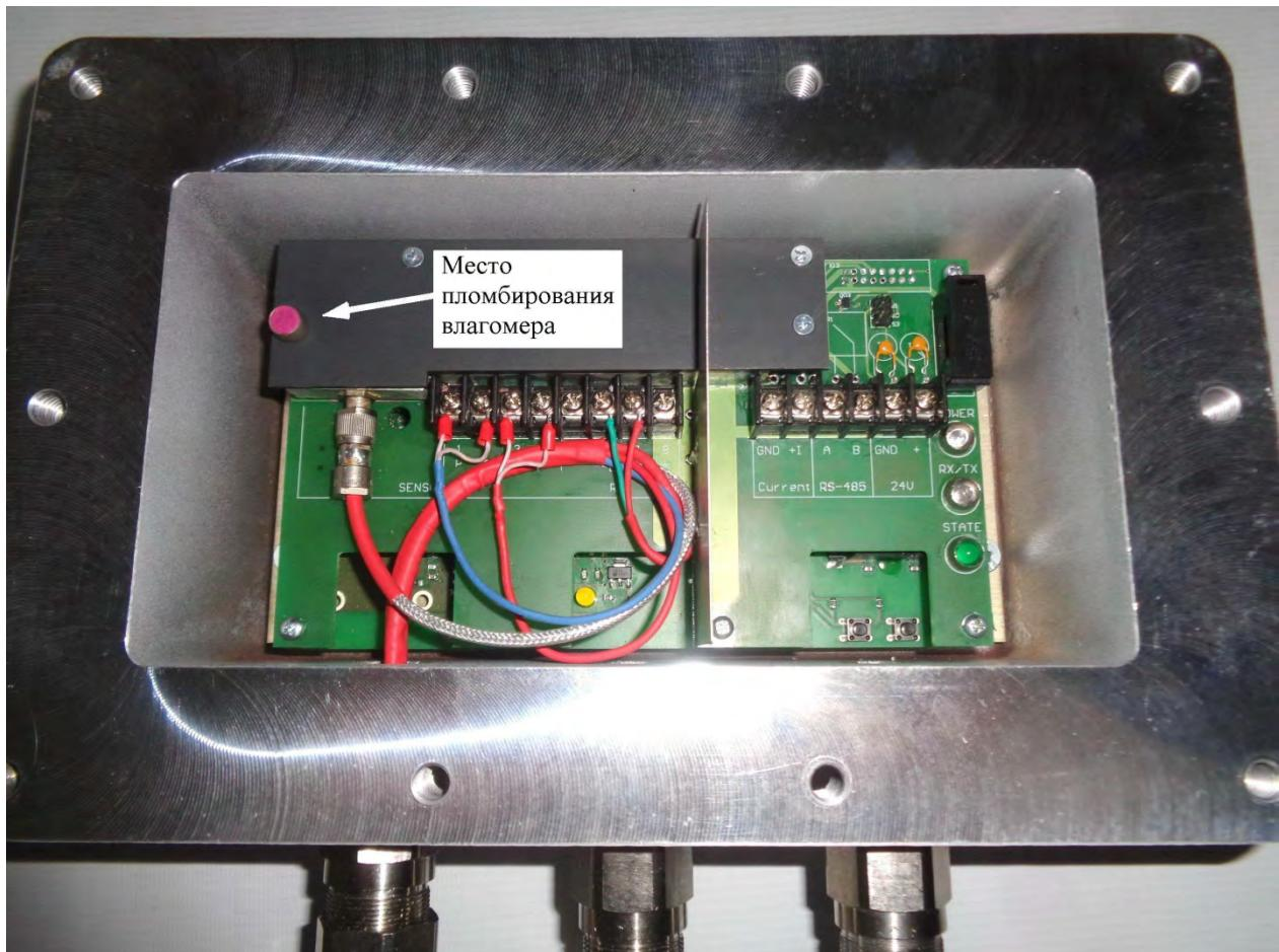
**Схема подключения влагомера FIZEPR-SW100
