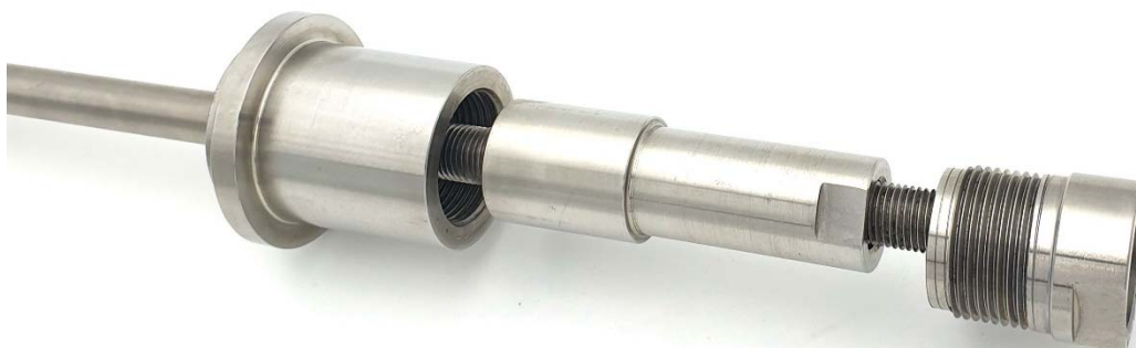
Задняя муфта в разобранном виде
